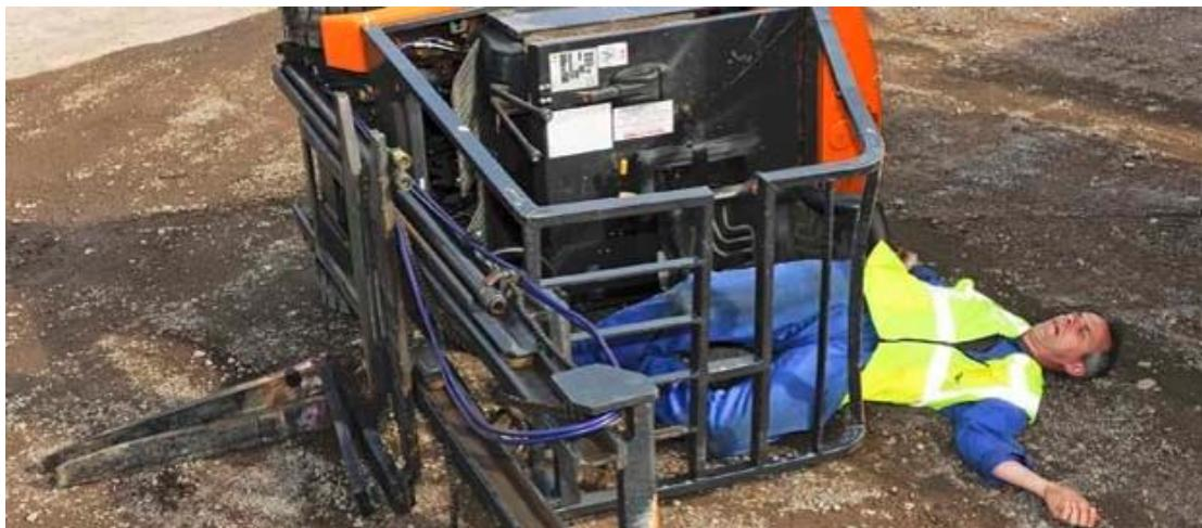
**Slika 2.** Primjer mehaničkih opasnosti pri radu sa samohodnim radnim strojevima
