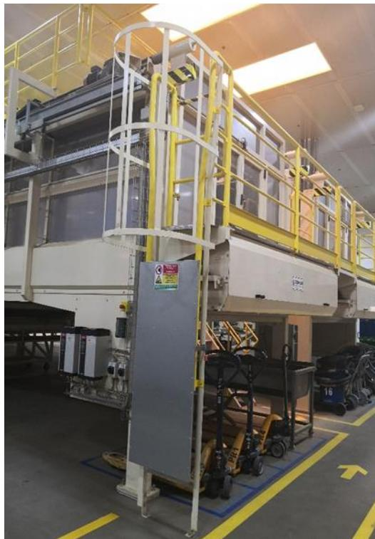
**Slika 51.** Vertikalne ljestve s leđobranom
